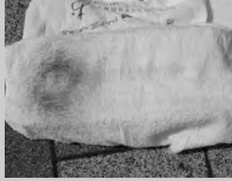
でより明確にわかる。左上写真の向かって左が塗布前、右が塗布後だ。塗布前にはほんの数秒で黒くできた排気管と比べると、塗布後にはほとんど見られない。平氏が過去に幾度となく繰り返し行った実験（二輪四輪問わず）でも同様の結果が出ており、エコマインドが燃料の完全燃焼化にいかにか効果的かがわかるだろう。そして結果的にこの「完全燃焼」が燃費の向上やトルクアップを生み出すわけである。
