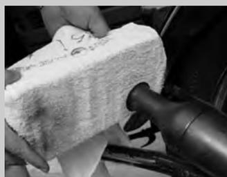
エコマインド塗布後、我々はすみやかに再び一酸化炭素（CO）と炭化水素（HC）の排出量を測定した。そこで出た数値が上の写真で右がXLH883、左が37年式EL。数値が軒並み低くなっているのがおわかりいただけるだろうか。要は不完全燃焼により発生する有毒排気ガスが激減し、排気ガスがクリーンになっているわけだ。これはエコマインド塗布前後にマフラーエンドに白い布を当てた実験
